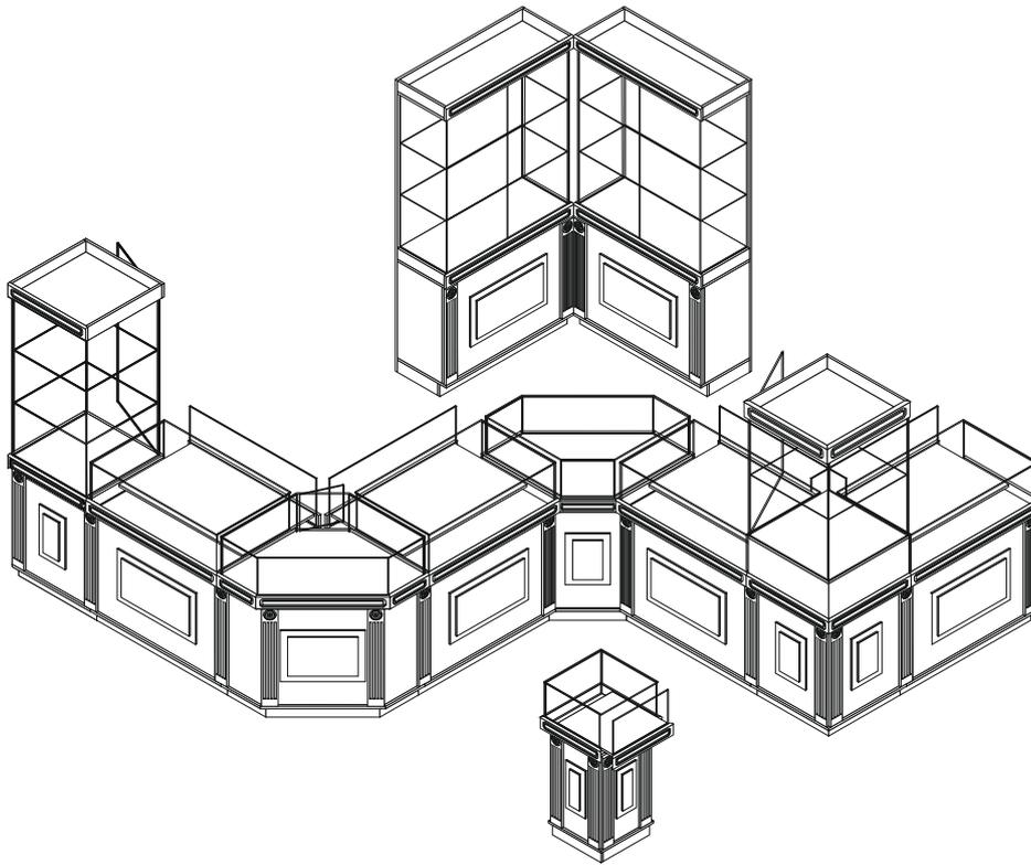
\* Фасады прилавков изготовлены по новейшей технологии вакуумного прессования путем нанесения плёнки на МДФ с последующим патинированием.
